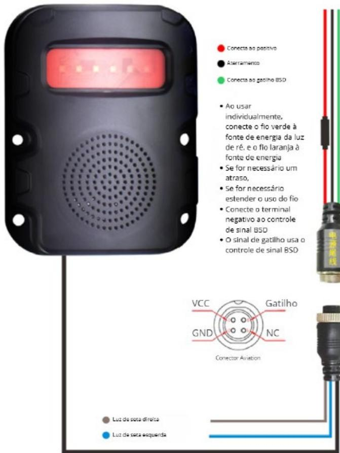
O sistema permite a integração com um alarme audiovisual externo, que tem como função alertar pedestres e ciclistas localizados nos pontos cegos ao redor do veículo.
