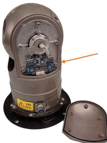
**Atenção:** Cuidado ao remover a tampa. Existe uma membrana de proteção contra água ao redor da carcaça.
